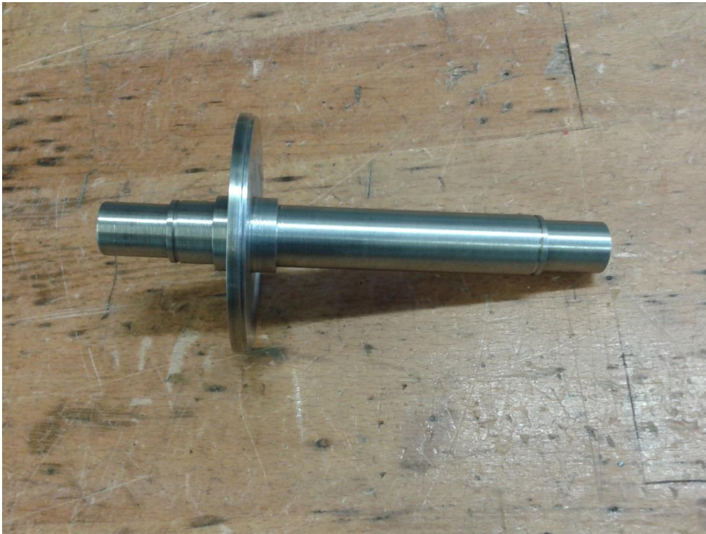
Bild 1: Gedrehte Antriebswelle aus schwer spanbarem Vergütungsstahl
