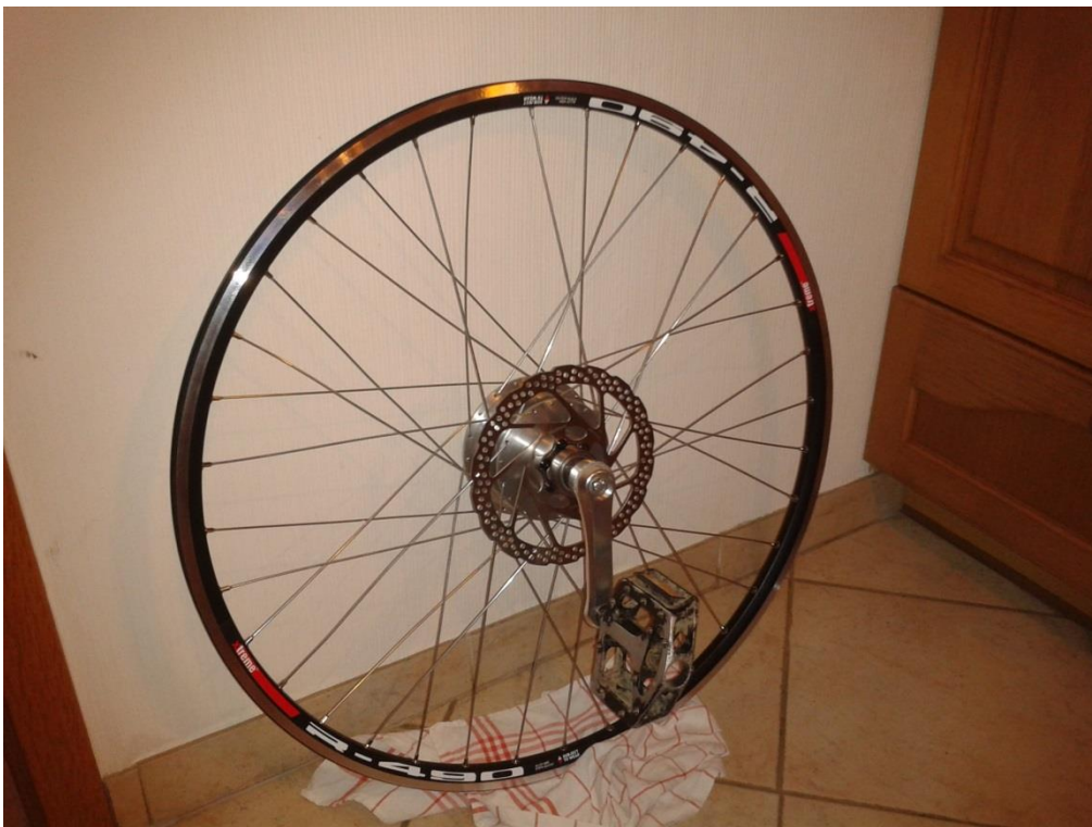
Bild 8: Eingespeichtes Rad mit Bremsscheibe
