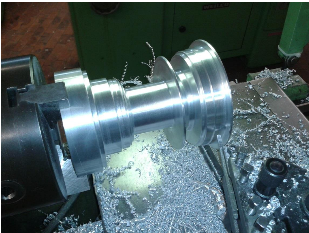
Bild 6: Drehen des Nabenaußenkörpers aus Aluminium
