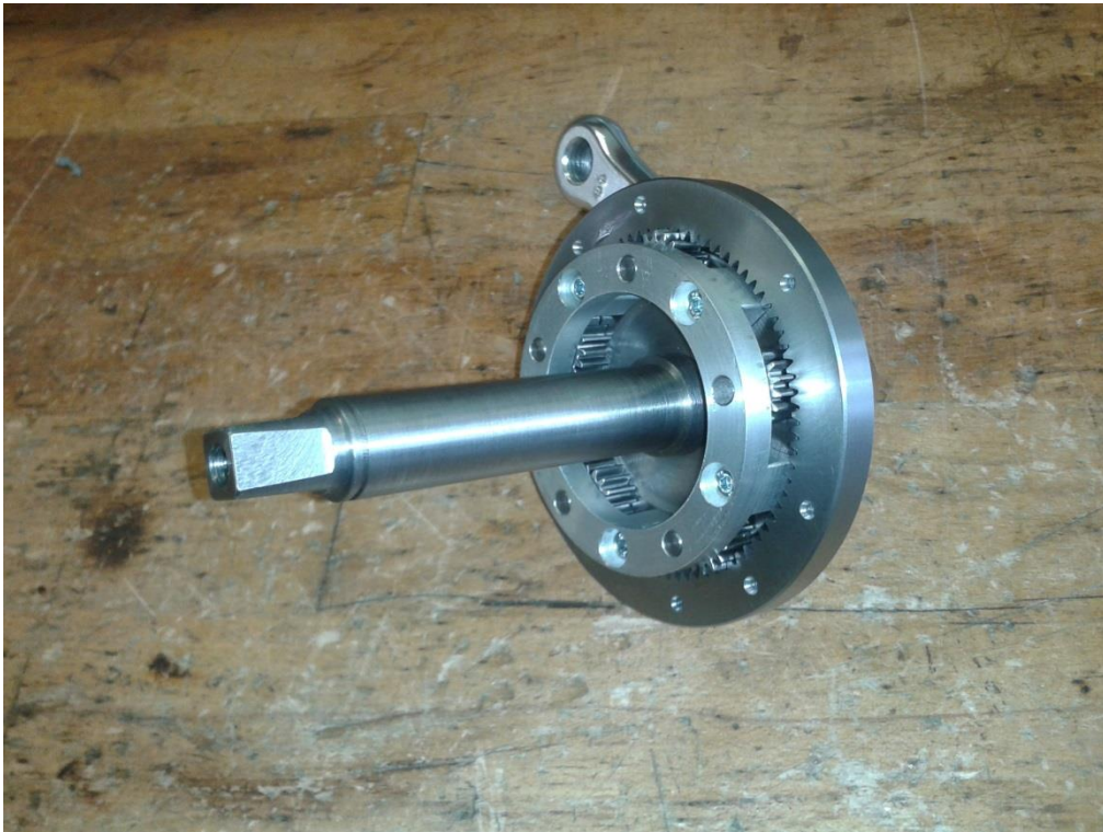
Bild 5: Montierter Planetenträger mit Hohlrads
