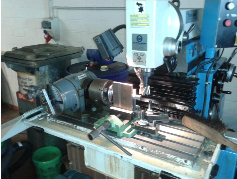
Bild 3: Fräsen der konischen Vierkantaufnahmen für die Kurbeln mit Hilfe eines Winkelverstellbaren Teilkopfs
