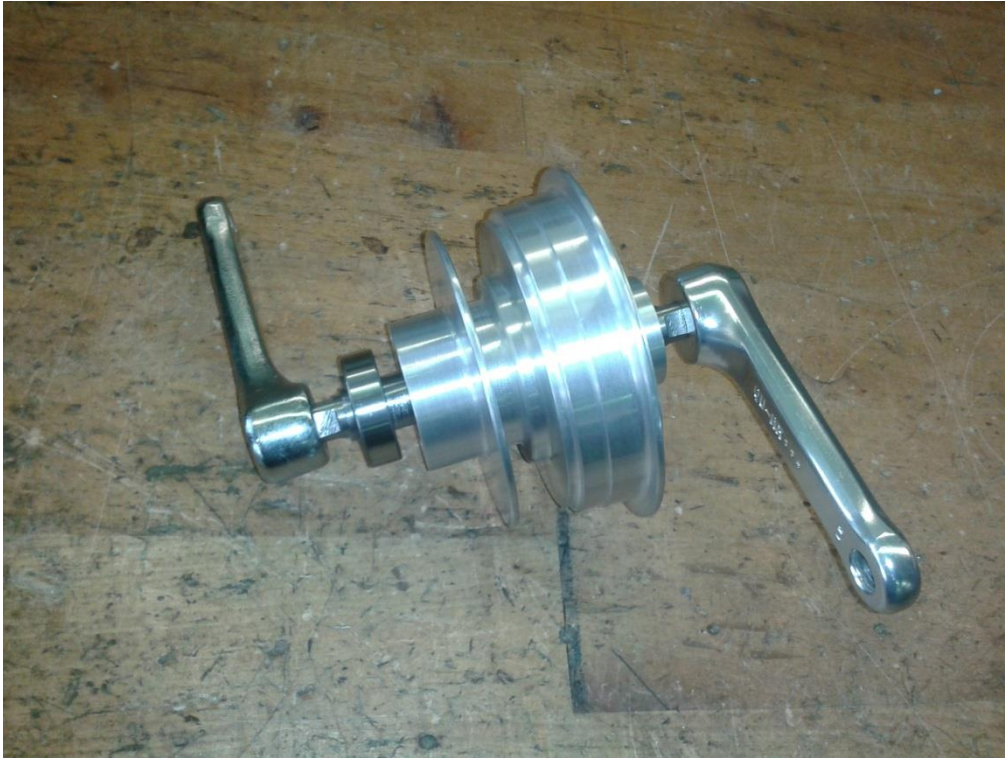
Bild 7: Montierte Getriebe­nabe (hier noch ohne Bohrungen für die Speichen)
